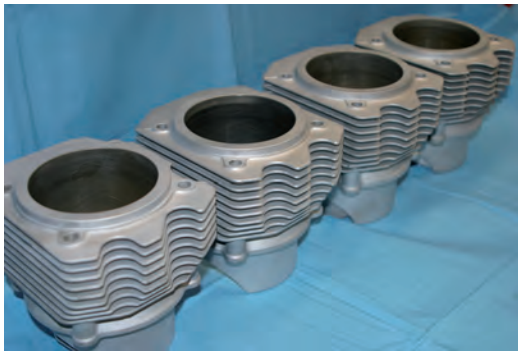
Cylindres et pistons nettoyés : une parfaite propreté n'est pas facultative !
