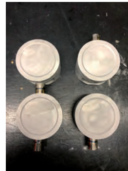
Cylindres et pistons nettoyés : une parfaite propreté n'est pas facultative !
