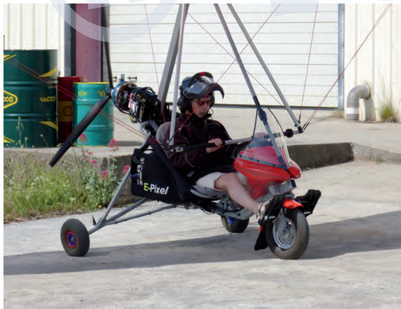
Le dernier-né d'Air Création : le monoplan E-Pixel à moteur électrique Geiger.
