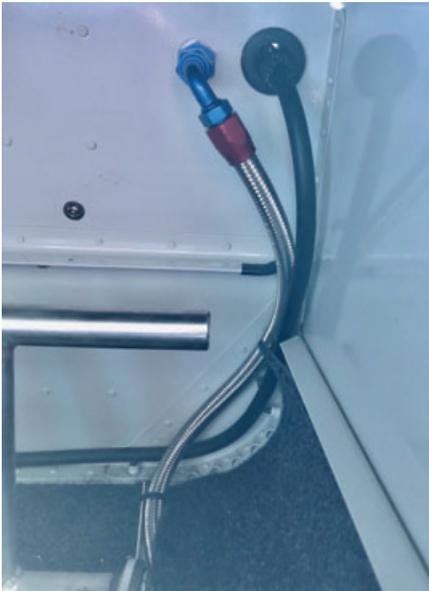
Comme sur tous les ULM, le passage à travers la cloison pare-feu des différentes durites ou câbles doit être soigné.
