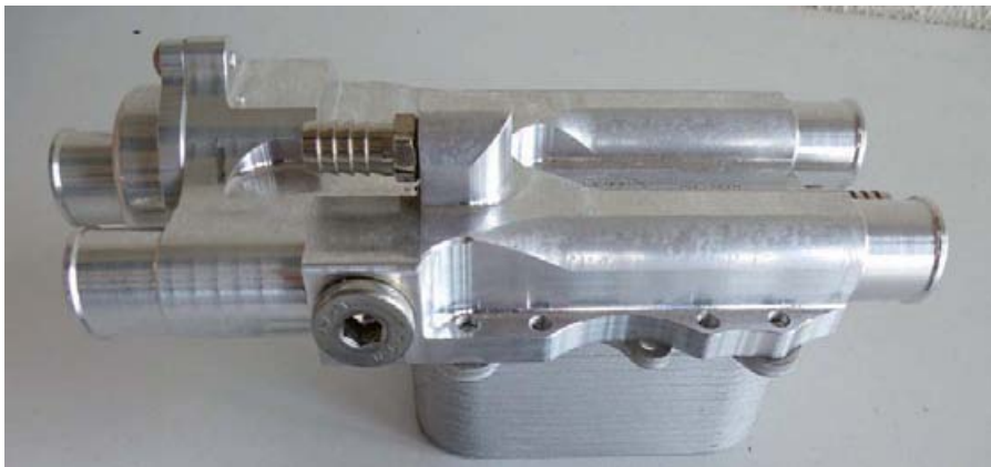
C'est la solution techniquement et thermiquement la plus aboutie. Elle nécessite de faire circuler les deux fluides à proximité immédiate l'un de l'autre à l'intérieur d'un « boîtier » contenant des circuits distincts où sont placés des calorstats. Appelés échangeurs, ces dispositifs permettent le partage calorifique entre les fluides.
