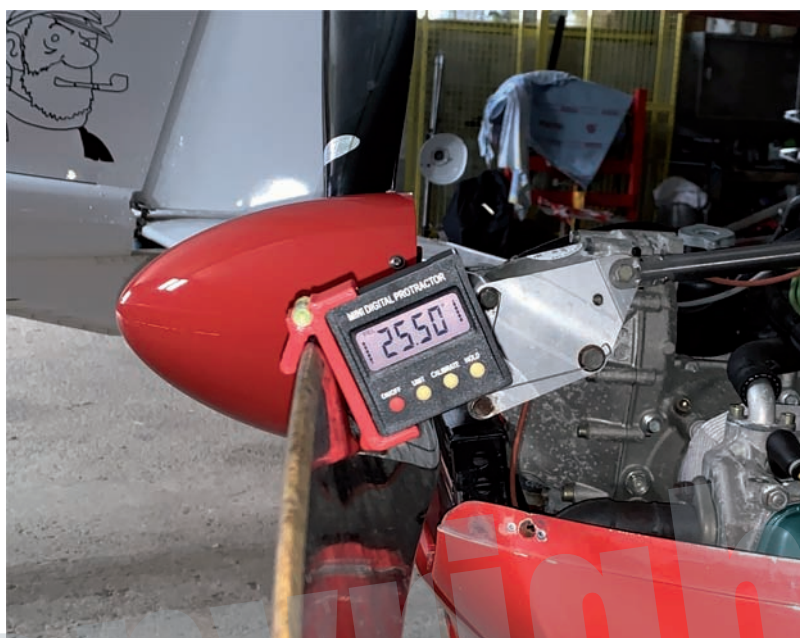
L'angle de calage des pales doit être vérifié avec un instrument adapté, ici celui que propose E-Props.
