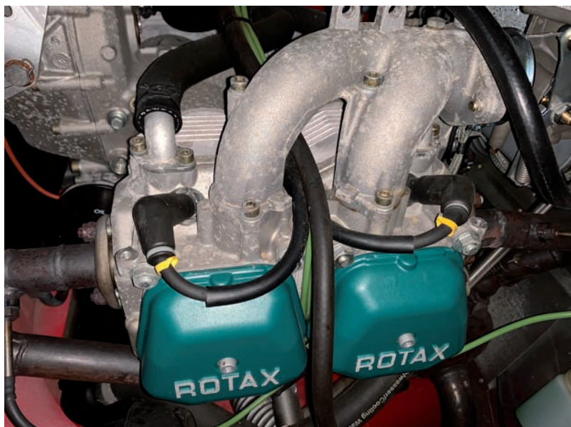
Les capuchons des bougies doivent tenir fermement et ne pas présenter de signes de vieillissement.
