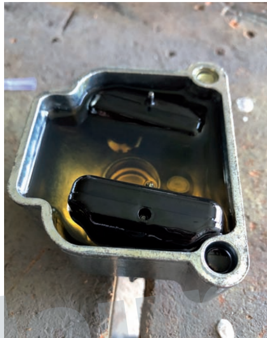
Vérifiez que les deux flotteurs de carburateur présentent la même flottabilité.
