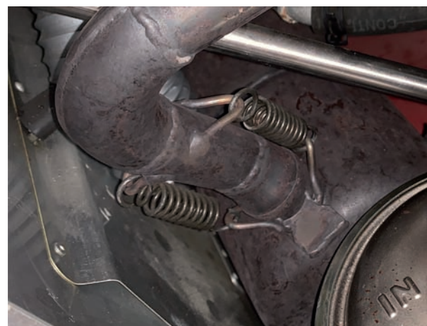
Vérifiez régulièrement les ressorts de maintien de l'échappement. S'ils rouillent, remplacez-les par des modèles en inox.
