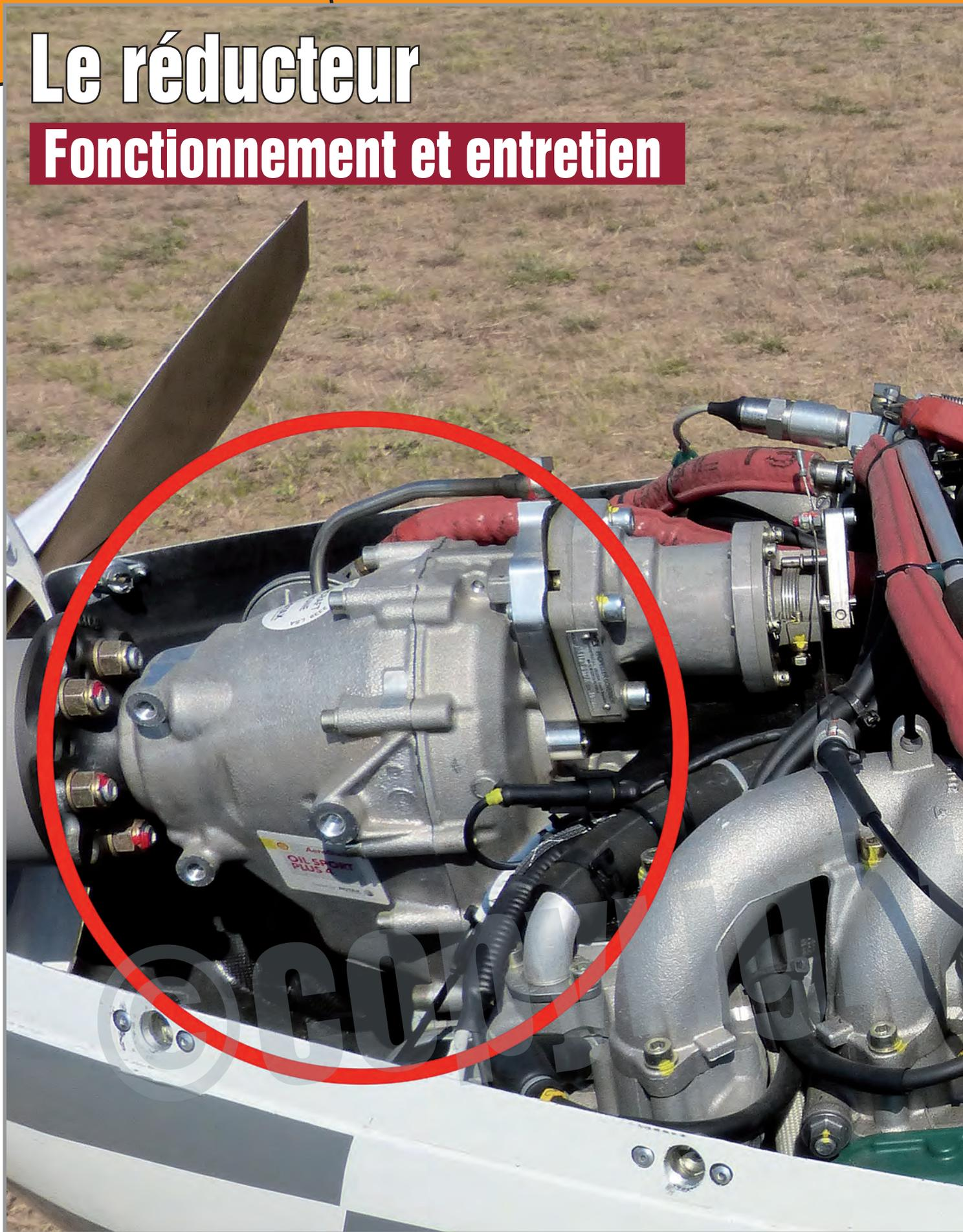
Le réducteur s'intercale entre le moteur et l'hélice. Une pièce maîtresse ! Il porte plutôt mal son nom, car la réduction du régime de rotation, du moteur à l'hélice, n'est qu'une de ses fonctions. Explications.
