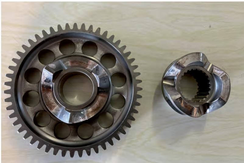
*Le crabot à « dents de chien » amortit les vibrations et les à-coups du moteur.*
